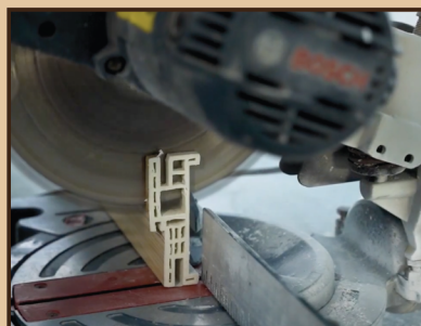
Bước 2: Cắt 2 gờ khung bao đứng
